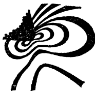
Рис. 12. Сложные деформации можно выявить при освещении прозрачной модели поляризованным светом.
